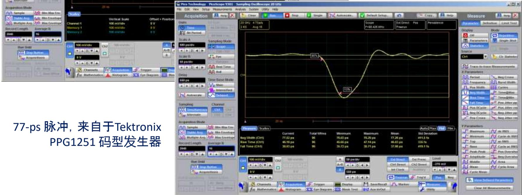
77-ps 脉冲, 来自于 Tektronix PPG1251 码型发生器
