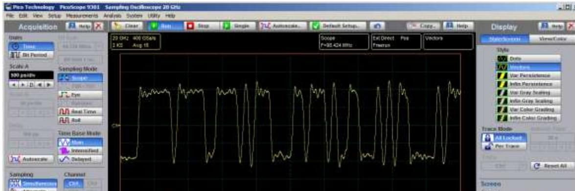
12.5-Gbps 码型, 来自于 Tektronix PPG1251 码型发生器
